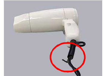
（事故品）電源コード根元付近に過度の屈曲が加わり、コード芯線が半断線したドライヤー
