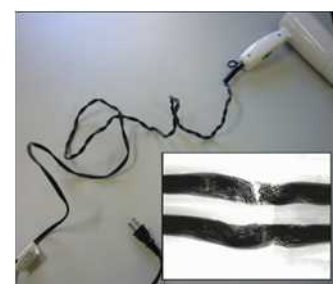
(写真) ヘアドライヤーの電源コードがねじれて芯線が断線した様子(右下は断線部X線映像)
